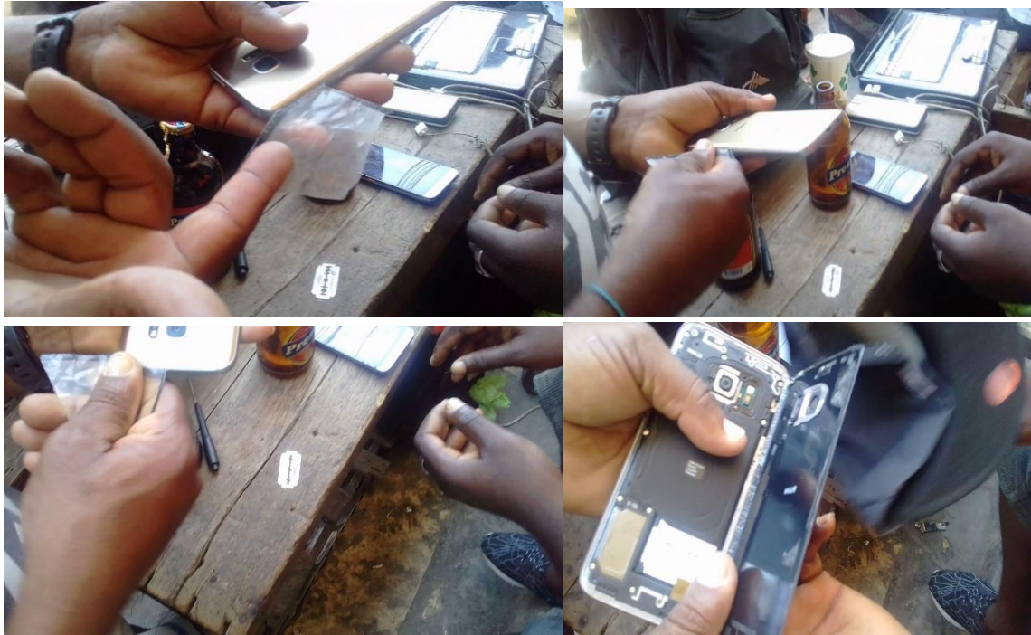
Figure 20: ouverture de la boîte d'un téléphone avec le "potouch"
